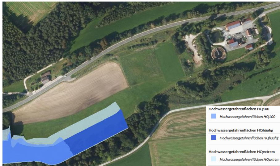
Abbildung 21: Überschwemmungsflächen für HQ häufig , HQ 100 , HQ extrem [1]
